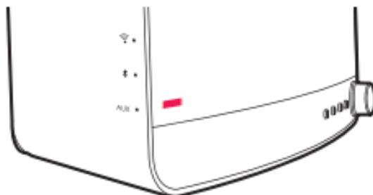
La batería está baja de carga. Después de parpadear, el indicador se apaga durante un instante. Si en este estado pulsa el botón INPUT en la parte delantera de la unidad principal, los indicadores parpadean para indicar que la carga de la batería es baja.
