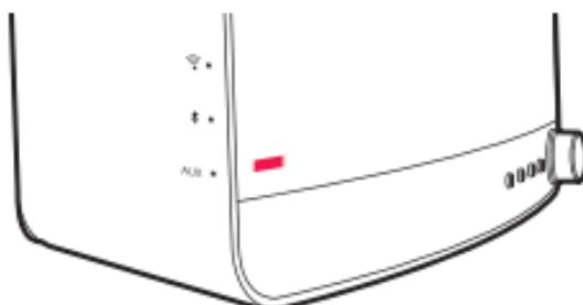
Die Akkuladezustand ist niedrig. Nach dem Blinken erlischt die Anzeige für eine Weile. Wenn Sie die INPUT-Taste an der Vorderseite drücken, während sich das Hauptgerät in diesem Zustand befindet, blinken die Anzeigen, um einen niedrigen Ladezustand des Akkus anzuzeigen.
