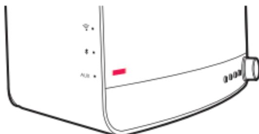
Er is weinig batterijlading. Na het knipperen gaat het controlelampje na een poosje uit. Als u in deze status op de voorkant van het hoofdtoestel op de INPUT-knop drukt, knipperen de controlelampjes om aan te geven dat er weinig batterijlading is.
