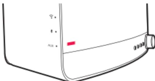
La batteria si sta scaricando. Dopo il lampeggio, l'indicatore si spegne dopo breve tempo. Se preme il pulsante INPUT sulla parte anteriore dell'unità principale in questo stato, gli indicatori lampeggiano per indicare che la batteria si sta scaricando.
