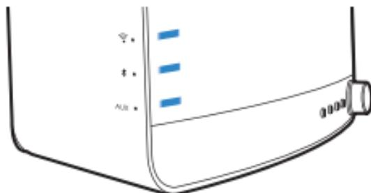
Er is een probleem met de batterij gedetecteerd.
