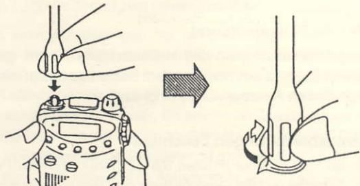
Die Antennenimpedanz beträgt in beiden Amateurfunkbändern  $50 \Omega$ , Sie können also auch eine andere Antenne mit der selben Impedanz im gewünschten Frequenzbereich mit entsprechendem Anschluß (oder über einen Adapter) hier befestigen.
